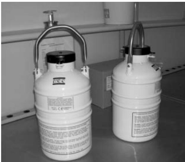
Fig. 1. Contenitori criogenici da 2,5 l di azoto liquido, trasportabili e sigillabili. *2.5 l liquid nitrogen cryogenic containers, transportable and sealable.*
